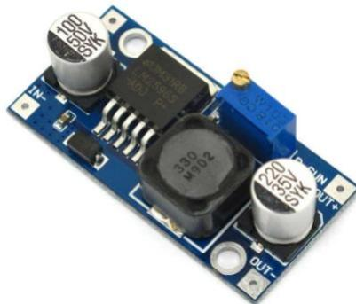
**Figura 7 Módulo LM2596 regulador de 1.5v a 30v**
