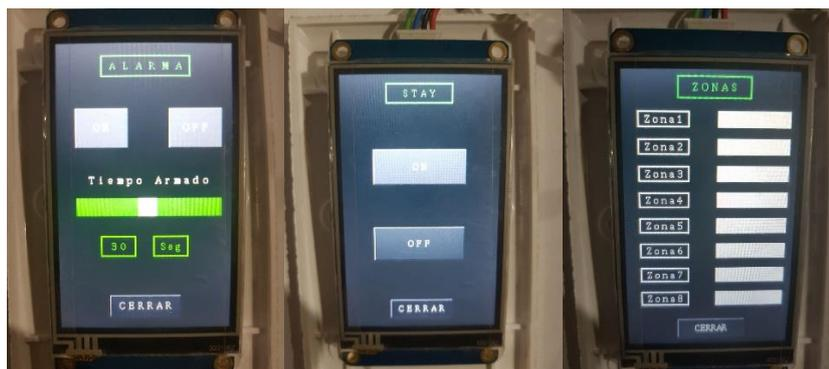
**Figura 109 Interfaces de las aplicaciones del sistema de seguridad**
