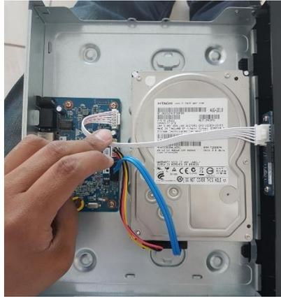
**Figura 102 Colocación de disco duro en el NVR**
