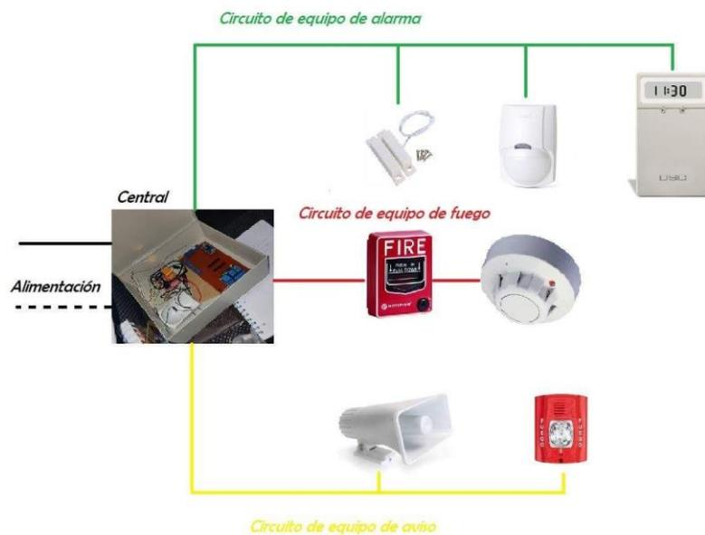
**Figura 29 Diagrama de sistema de alarma contra intruso e incendio**
