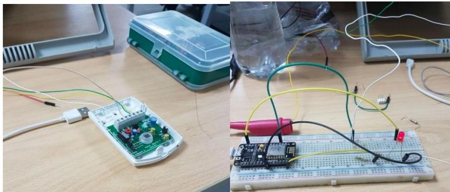
**Figura 106 Conexión de sensor de movimiento y microcontrolador NodeMCU**
