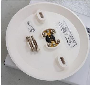
**Figura 17 Sensor de Temperatura**
