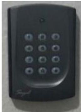
**Figura 4 Control de acceso teclado y tarjeta**
