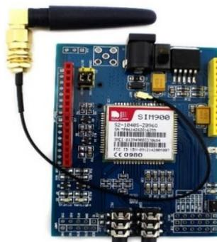
Figura. 1.23. MODULO GSM GPRS SIM900
