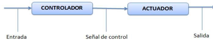
Figura. 1.3. Sistema de Control de lazo abierto
