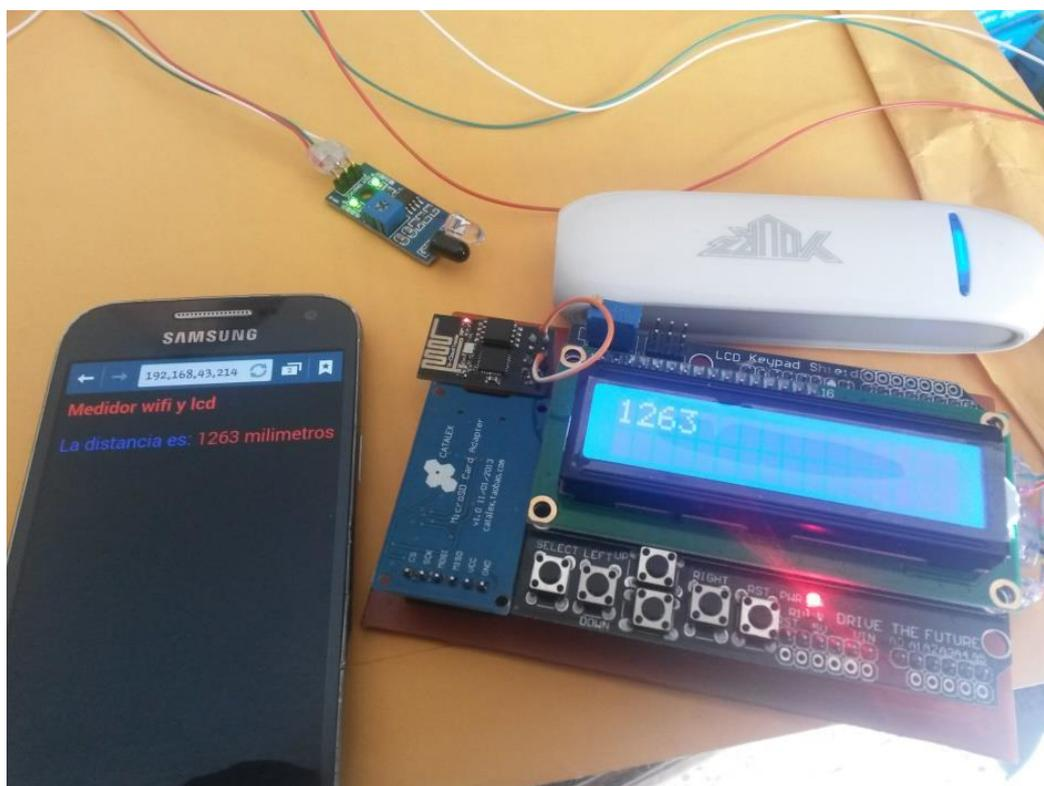
Figura 3.8 circuito terminado y comprobado su funcionamiento. (El Autor, 2018)
