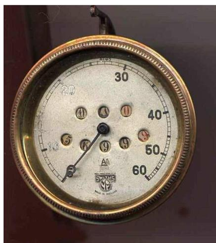
**Figura 1.3** Ejemplo de Odómetro antiguo. (Victor, 2008)
