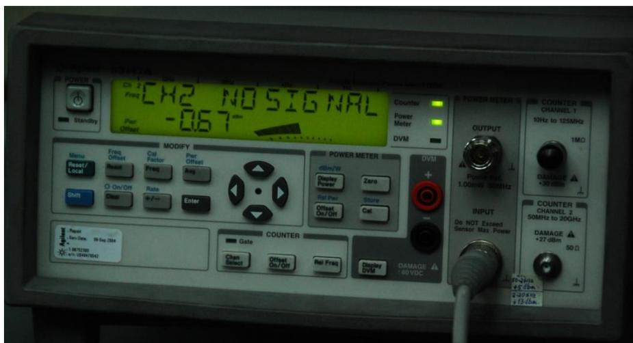
**Figura 4.1.9 Lectura resultante de la medición de pérdidas en el cable LMR-400 en el Power Meter.**
