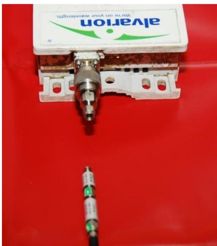
**Figura 4.1.12 Momentos antes del acople de los atenuadores y la línea de transmisión con el puerto de antena del radio.**
