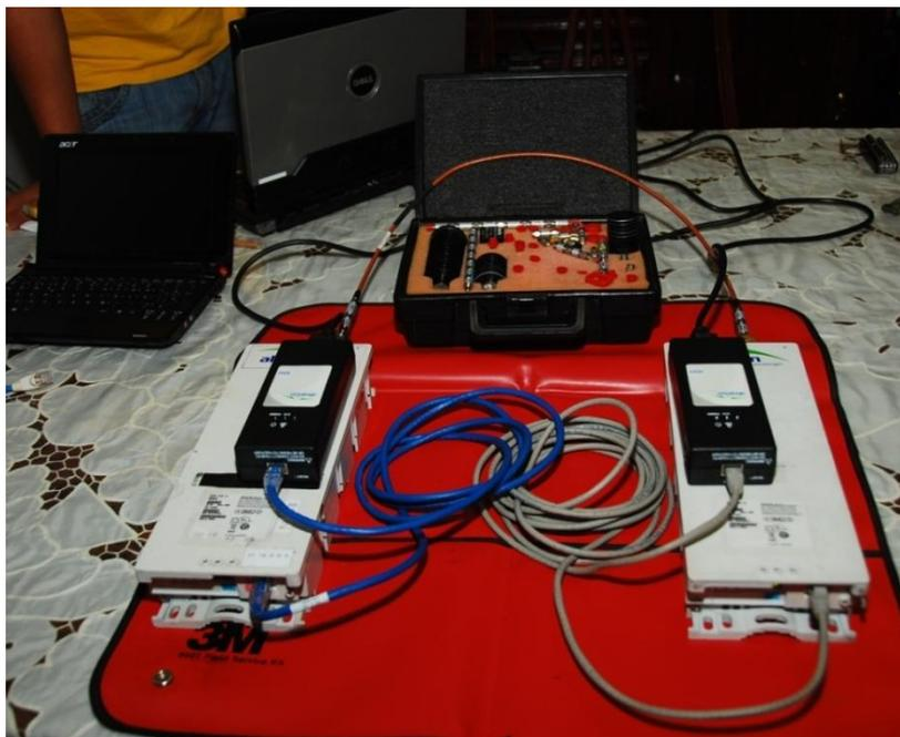
**Figura 4.1.14 Unidad ODU<sup>65</sup> e IDU de los dos radios conectadas a través de dos patch -cord.**
