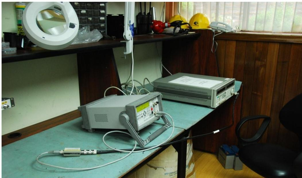
**Figura 4.1.7 Conexión final para las pruebas con el cable LMR-400.**
