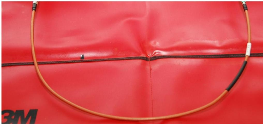
**Figura 4.1.5 Línea de Transmisión (Baja Perdida)**
