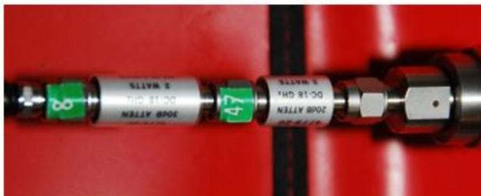
**Figura 4.1.11 Atenuadores conectados al puerto de antena del radio**
