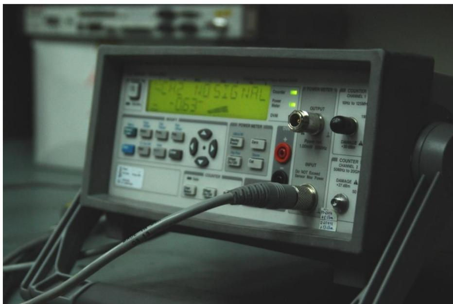
**Figura 4.1.2 Power Meter (Agilent 53147A)**
