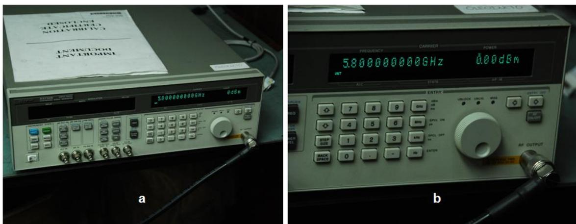
**Figura 4.1.8 a y b Generador de Frecuencia ajustado a 5.8 GHZ**
