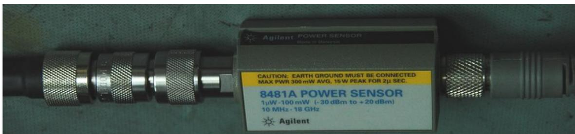
**Figura 4.1.6 Cable LMR-400 conectado al extremo izquierdo (IN) del Power Sensor y al extremo derecho (OUT) el Power Meter.**
