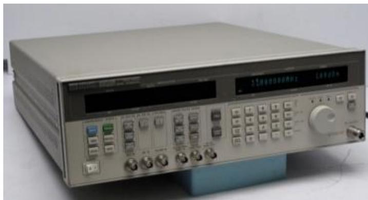
**Figura 4.1.1 Generador de Frecuencia (Agilent 83732B)**
