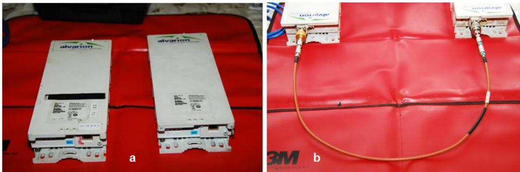
**Figura 4.1.13 a) Radios Alvarion sin conexión entre puertos de antena. b) Conexión entre puertos de antena de los radios a través de atenuadores y línea de transmisión de baja pérdida.**
