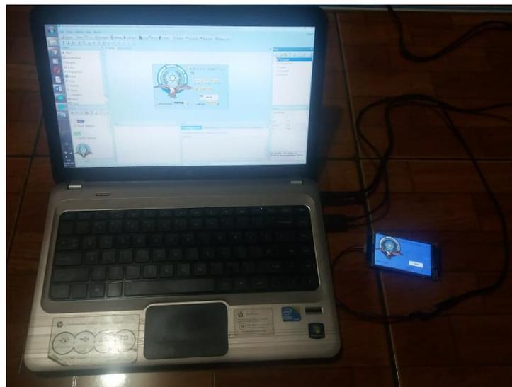
Figura 39 Subida del software a la pantalla nextion
