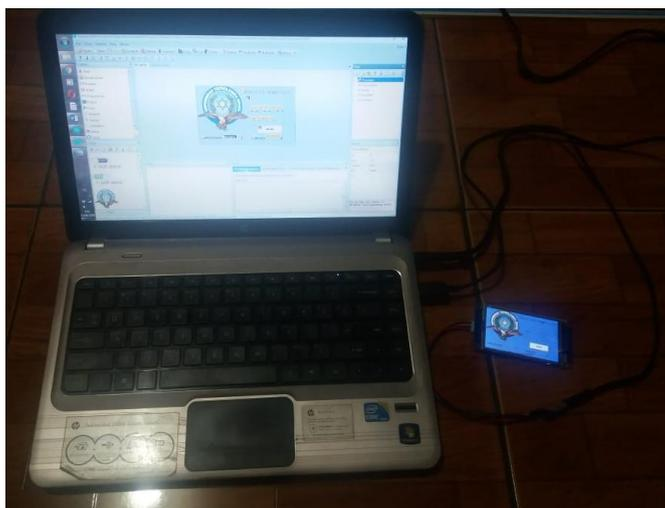
Figura 75 Subida del software a la pantalla nextion
