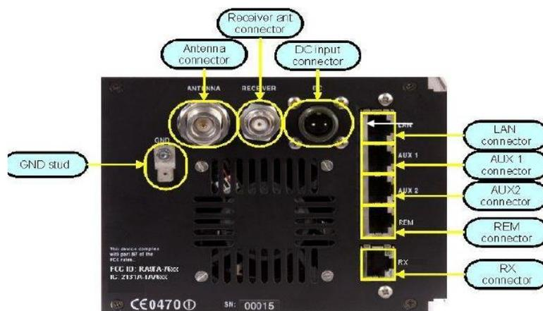
Figura 1.10.- Conexión posterior del Trasmisor JOTRON
