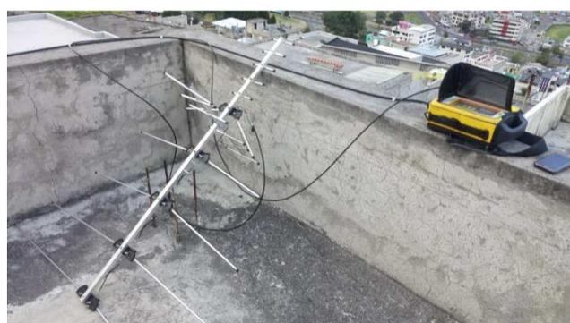
Figura 3.23: Mediciones del MER con una antena casera.
