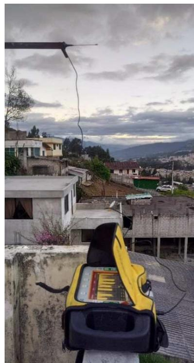
Figura 3.22: Mediciones del MER con una antena digital.
