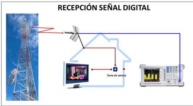
Figura 3.18: Segundo punto de medición del error de modulación.
