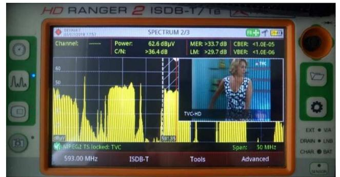
Figura 3.19: Imagen de la toma de mediciones en el canal Televisión.
