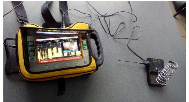
Figura 3.20: Mediciones del MER canal Televisión.
