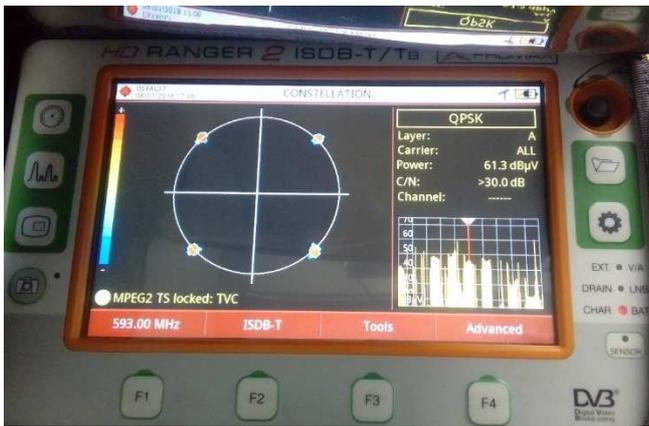
Figura 3.24: Diagrama de constelación de la señal digital.
