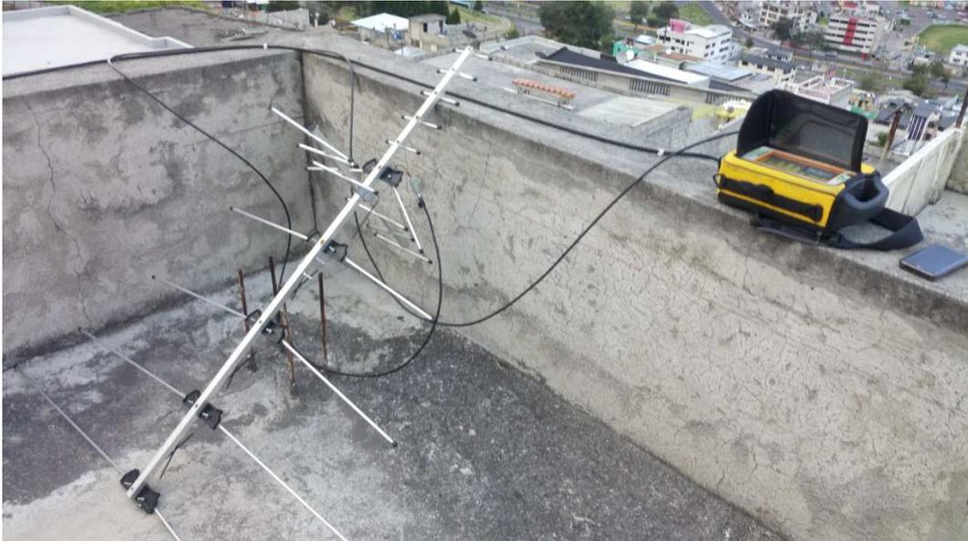
Figura 3.23: Mediciones del MER con una antena casera.
