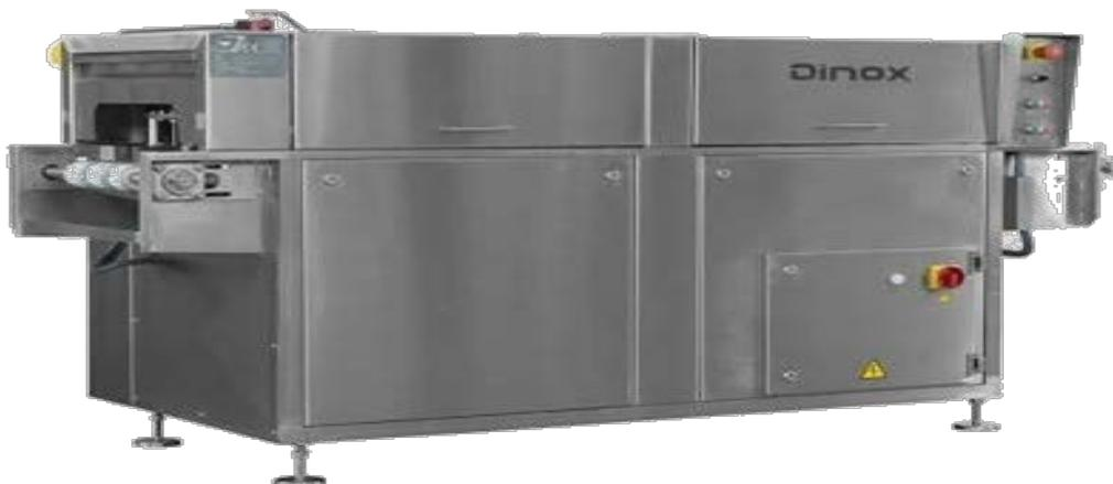
Figura 20 Túnel de secado
