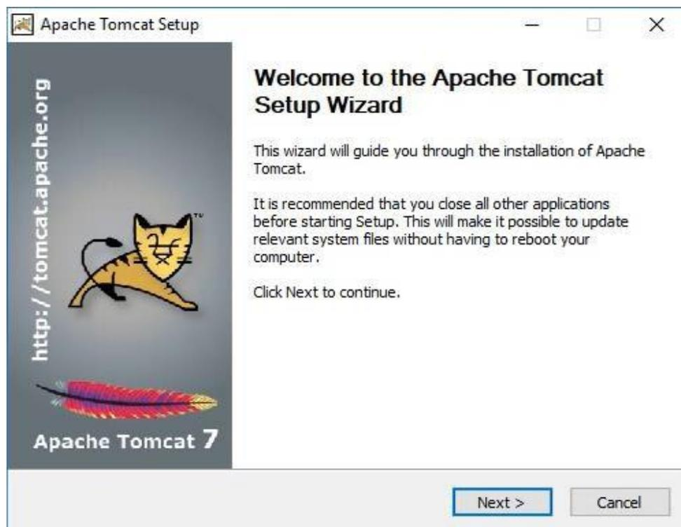
**Imagen 11:** Ejecutar el .exe apache-tomcat-7.0.50, hacer clic en "Next" para continuar con la instalación.
