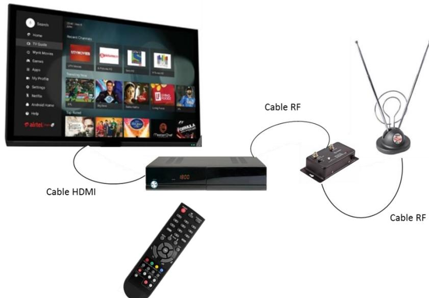
Figura 2.6 Esquema de conexión de equipos
