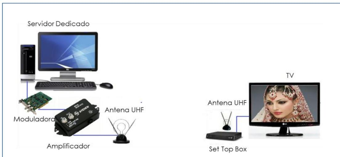
**Figura 3.2.** Esquema de transmisión de la App interactiva
