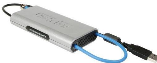
**Figura 3.2.** Tarjeta moduladora Dectek DTU215
