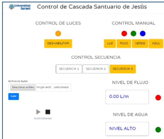
7. En la parte superior derecha se tiene el control manual de iluminación, basta con dar clic en el color del LED que se desea encender, se tiene los 3 colores primarios digitales RGB rojo verde y azul, pero se puede combinar el encendido de estos LEDs para generar más colores.
