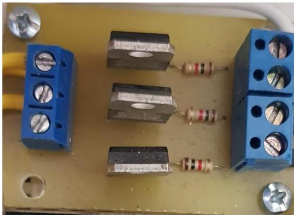
Figura 51 Montaje de potencia
