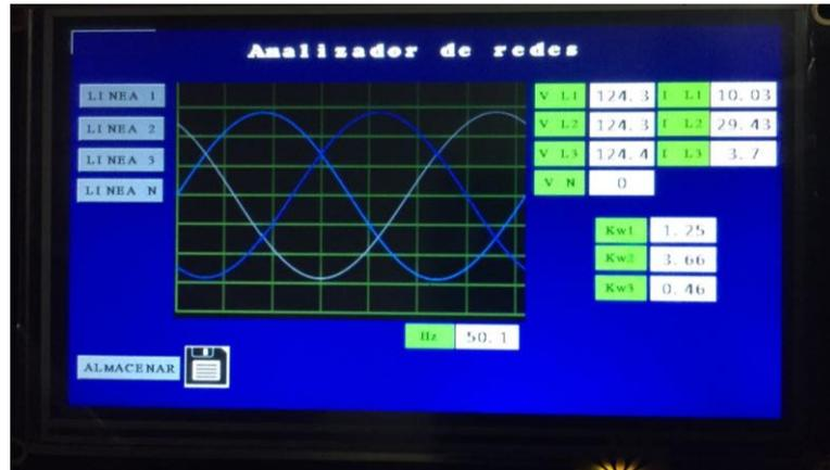
Figura. 3.31. Gráfica senoidal de voltaje de línea.
