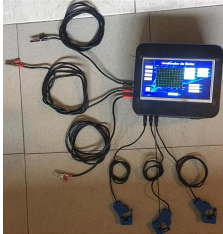
Figura. 3. 2. Equipo Analizador de redes Eléctricas.
