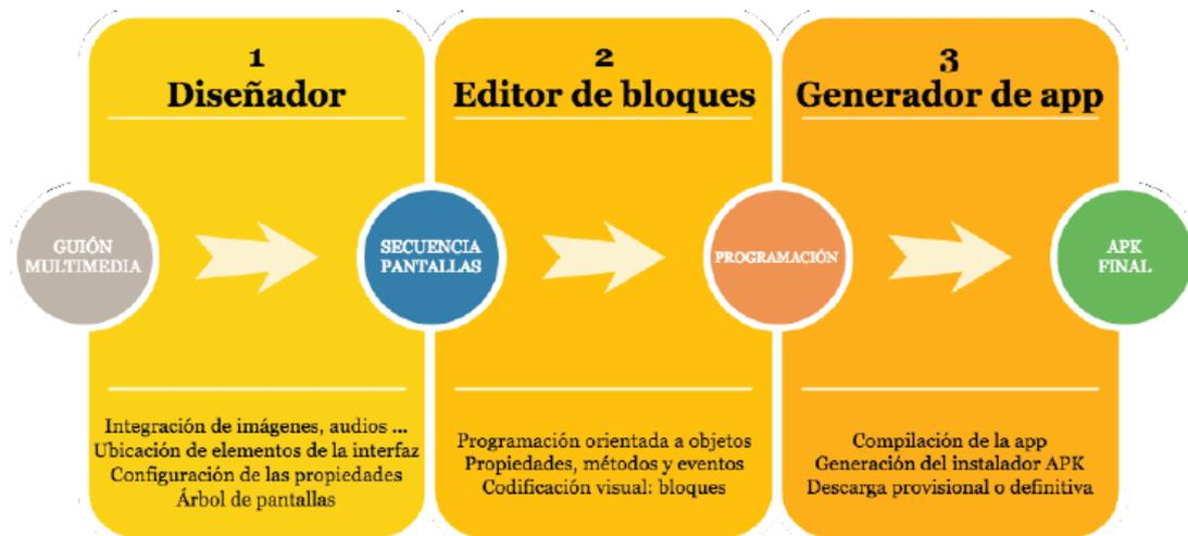
**Figura 1.13** Proceso de creación de una app con MIT App Inventor
