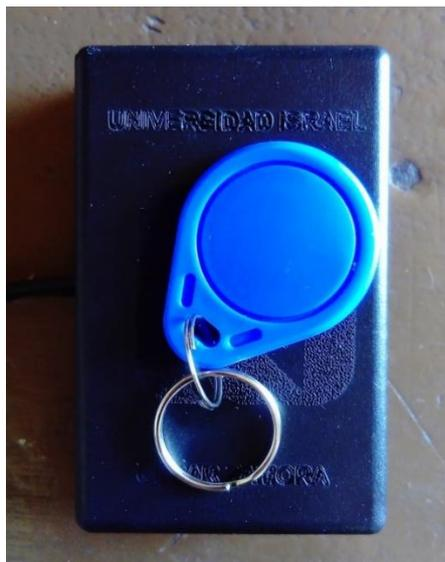
Tag NFC sobre el dispositivo programador
