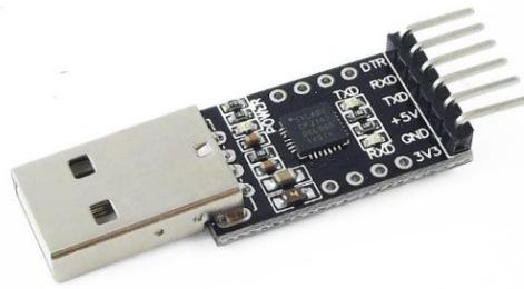
**Figura 3.7 Módulo CP2102 Conversor USB a TTL**
