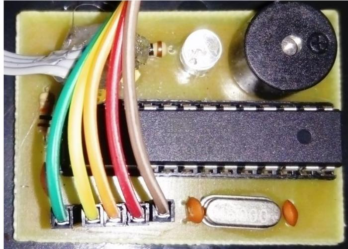
**Figura 4.5 Placa Electrónica del Programador NFC**
