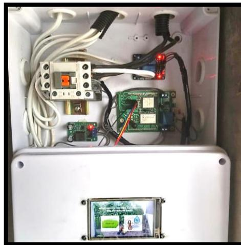
Figura. 4.21. Conexión de pantalla HMI
