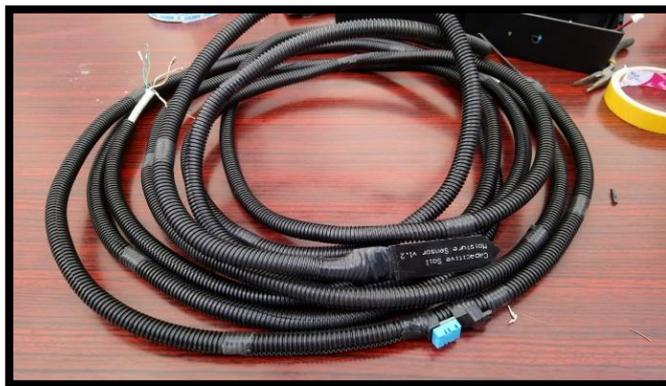
**Figura. 4.11. Cables de sensores aislados**
