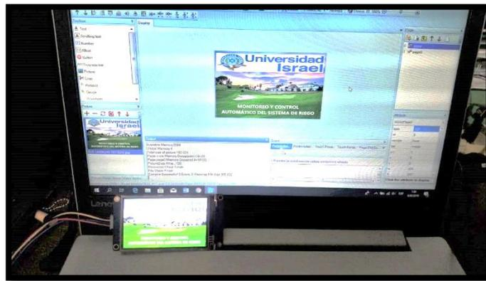
**Figura. 4.6. Diseño del software de la pantalla HMI**
