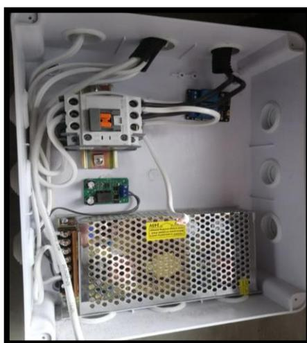
**Figura. 4.19. Conexión de fuente de alimentación**
