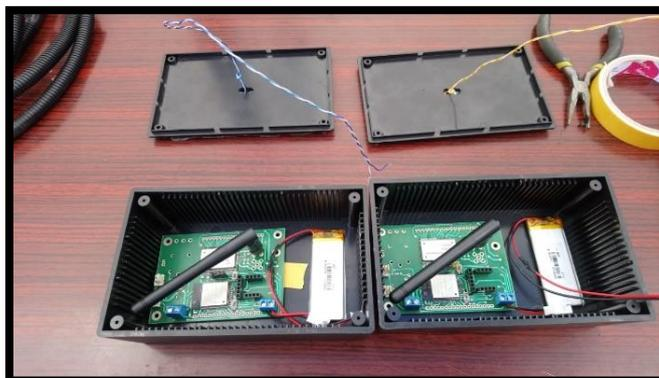
**Figura. 4.12. Conexión de los módulos esclavos**
