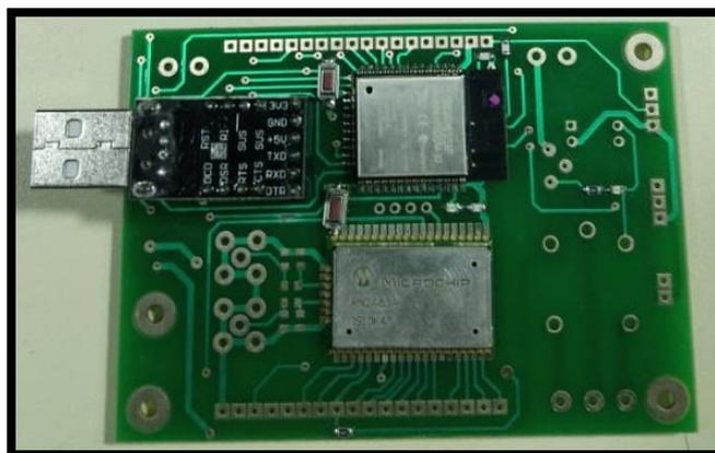
**Figura. 4.3. Placa de control con sus elementos**
