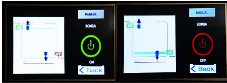
Figura. 4.23. Pantalla HMI en forma manual
