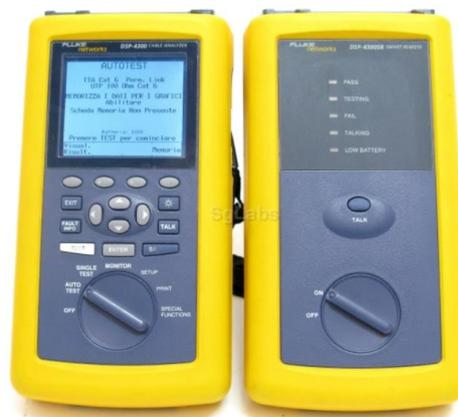
Figura 4. 25 Equipo Fluke DSP 4300
