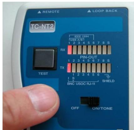
Figura 4. 24 Herramienta para las pruebas de conectividad
