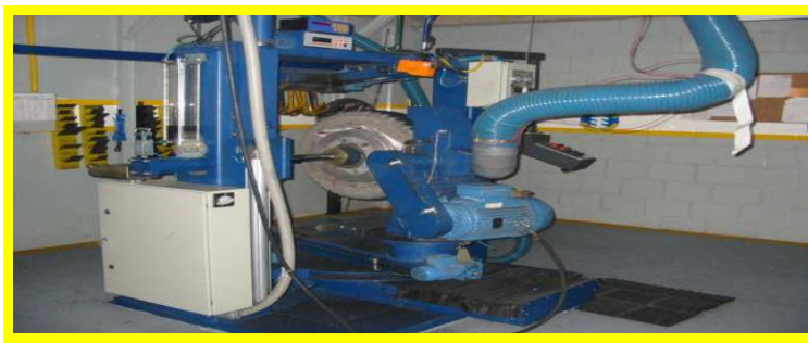
Gráfico 19. Proceso de Reencauche: Respaldo
