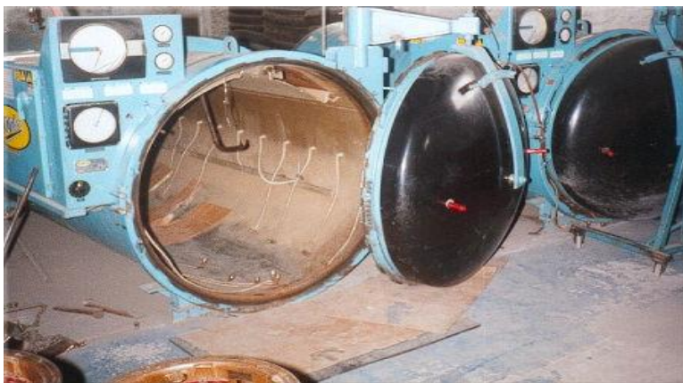
Gráfico 24. Proceso de Reencauche: Vulcanizado
