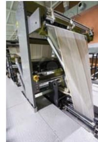
Fig. 1: Offset de Bobina
