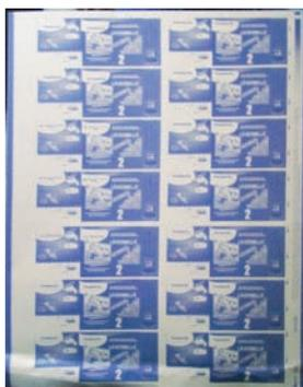
Fig. 3: Placa de impresión metálica
