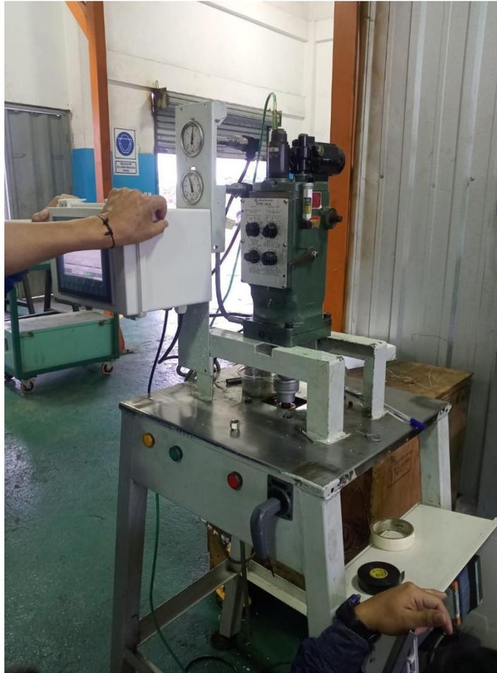
Fig. 10.1. Trabajos de ensamblaje en la estructura metálica del banco de pruebas de gobernadores para control de velocidad en motores de generación.
