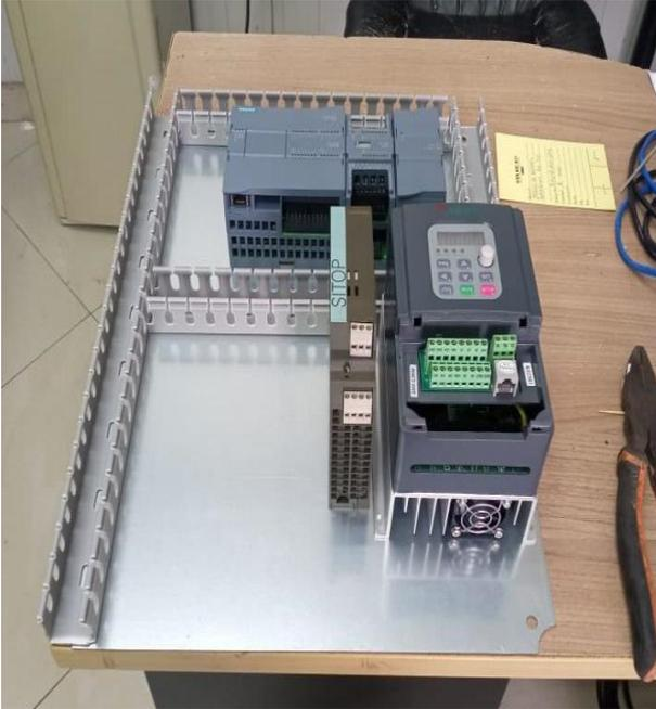
Fig. 8.1. Corte de tablero y canaletas
