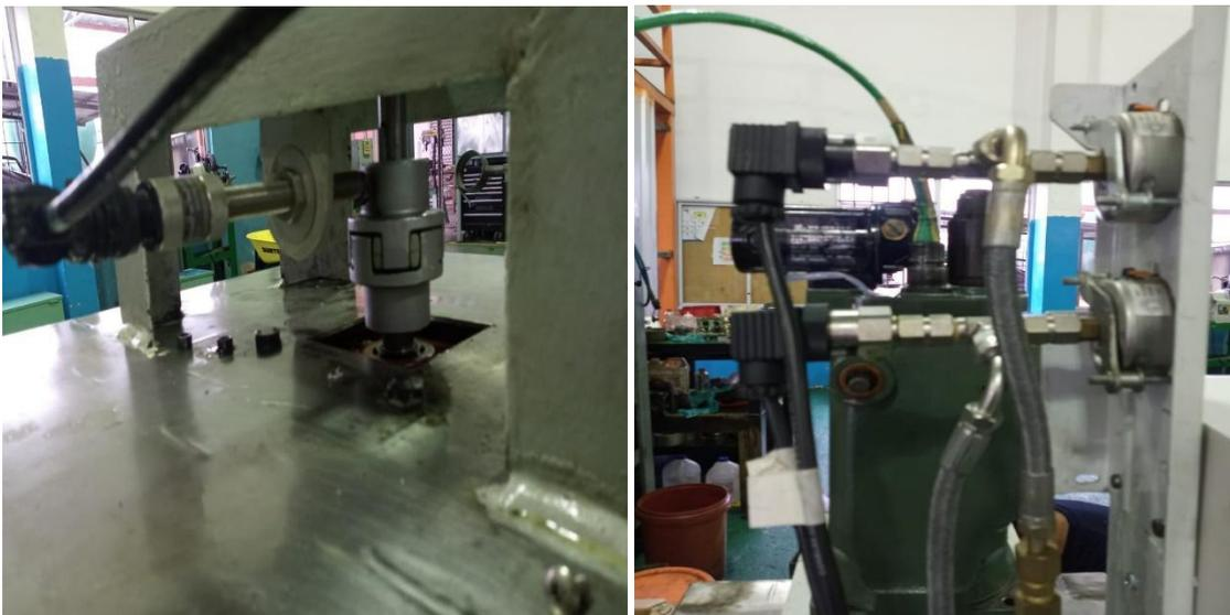
Fig. 10.2 ubicación del sensor de velocidad. Fig. 10.3. ubicación de los transductores de presión
