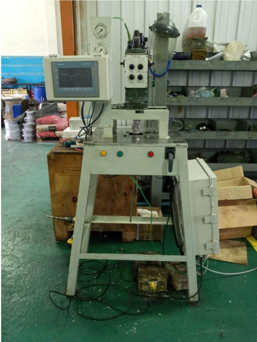
Fig. 10.0. Ensamble del banco de pruebas de gobernadores para control de velocidad en motores de generación.
