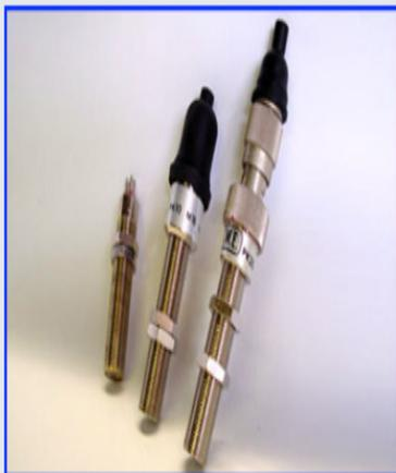
Sensor, Transductor (MPU); Se ubica en la cercha del motor Diesel. Para aplicaciones con Governador electrónico de velocidad. Genera una señal de tipo sinusoidal con una determinada frecuencia de trabajo.
