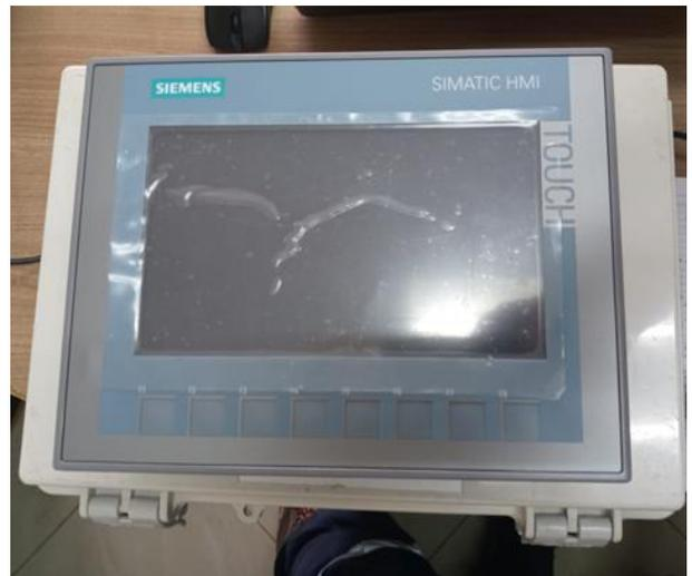
Fig. 8.6/8.7 Corte del panel de control plástico para alojamiento de la pantalla de operación KTP-700
