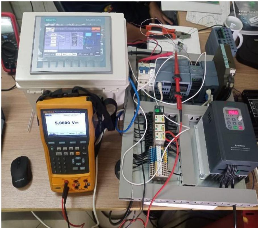
Fig. 8.10. Calibración de las señales analógicas mediante el ensayo con el equipo calibrador documentador de procesos Fluke.
