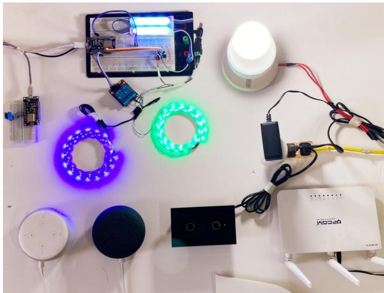
Figura 21. Prototipo de la arquitectura propuesta
