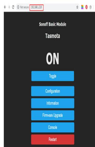
Figura 9. Interfaz Tasmota para configuración del firmware
