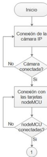
Figura 9. Diagrama de flujo conexión de los elementos del sistema.
