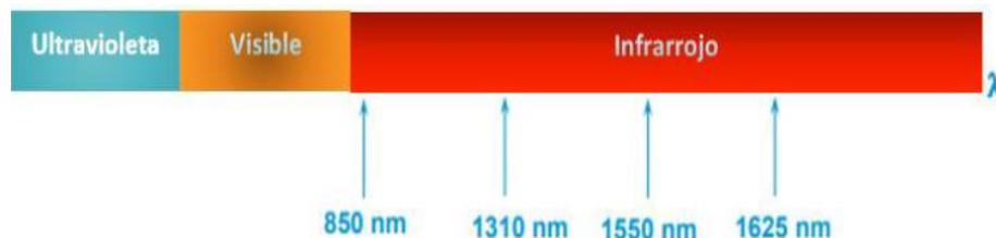
*Figura 7. Ventanas de transmisión*
