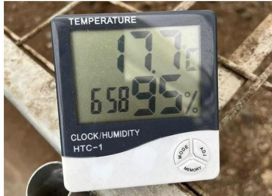
La recolección de datos se realizó con un sensor de temperatura y humedad HTC-1, este sensor se utilizó a lo largo de todo el proceso de recolección de datos ya que, ofrece medidas confiables de acuerdo con el encargado de la industria.
