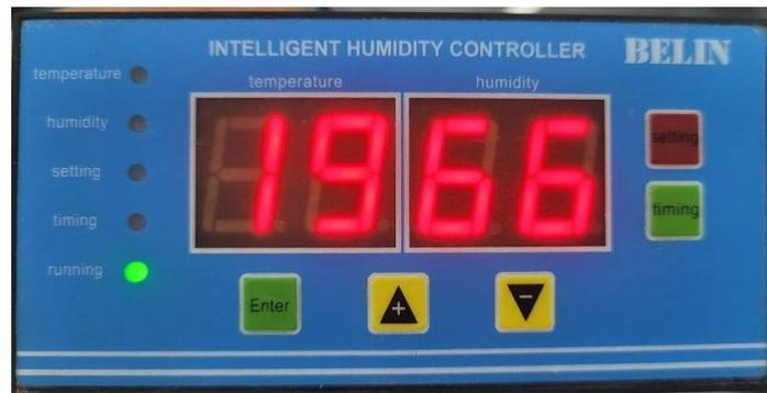
La Figura 22 muestra la parte frontal del controlador de humedad inteligente BELIN.
