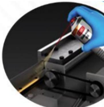
*Nota:* la figura muestra la correcta colocación de aceite para lubricación.
