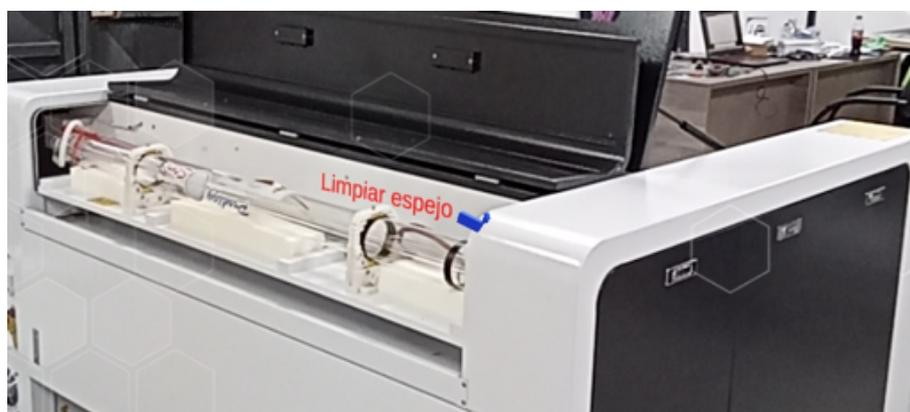
En la Figura 22 se muestra el tercer espejo, que incluye el lente de enfoque y se puede realizar el mantenimiento adecuado e indicado en el apartado 2.1.1.
