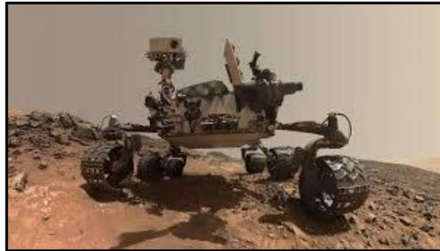
**Nota:** “Este laboratorio rodante cuenta para facilitar su desplazamiento por tierras marcianas con seis ruedas, cada una de ellas equipada con su propio motor. Además, cuatro de ellas (las dos delanteras y traseras) disponen de motores individuales de dirección, con lo que es posible que el “rover” pueda girar 360 grados sobre sí mismo.” (Yllera, 2011)
