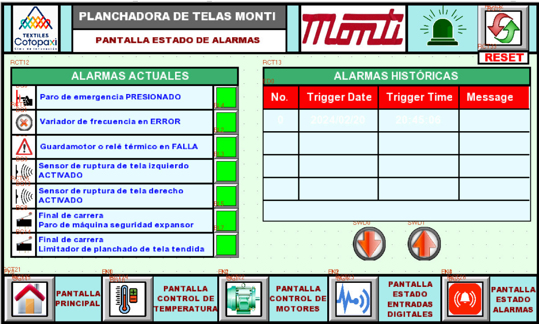
Pantalla estado alarmas
