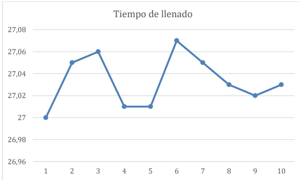
En la figura 23 se observa el comportamiento de pruebas de los tiempos tomados se obtuvo que el tiempo de llenado de una botella es de un promedio de 27.00 segundos según la tabla 3. El tiempo de llenado para una producción a gran escala disminuye si se utiliza una bomba de agua de una potencia superior.
