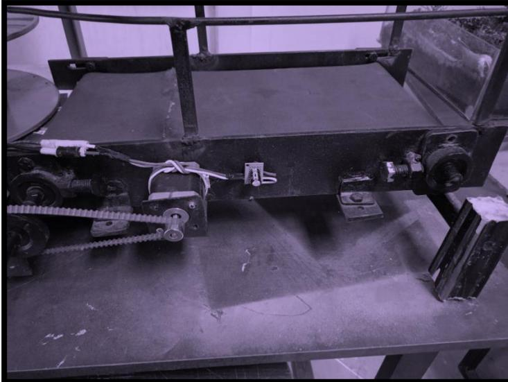
En la figura 4 se evidencia la banda transportadora para movilizar las botellas y llevarlas al plato para empezar con el proceso de llenado, tapado y sellado.
