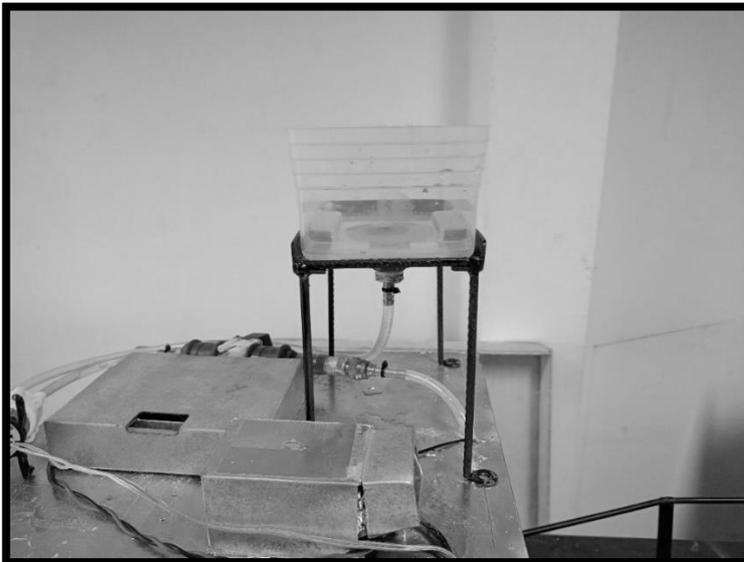
Figura 9, reservorio donde se coloca podemos colocar el líquido del cual va a llenar la botella, en este caso de uso solo agua.
