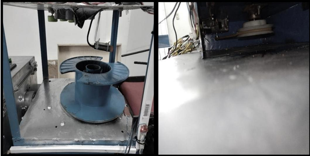
En la figura 6, se evidencia el plato giratorio para mover la botella a las diferentes etapas del sistema, controlado de igual forma con un motor paso a paso y un capacitor de 1000 uf y 25 v.
