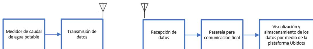
Como se puede verificar en la **Figura 2** el prototipo cumple con las características principales de una red LoRaWAN, es decir constan de un nodo el cual es el encargado de captar los datos los mismos que se transmitirán a un Gateway que trabajará a una frecuencia
