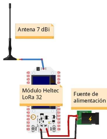
De igual manera que en el módulo emisor se desarrolló el diagrama de pistas en el software *EasyEDA*, como se puede observar en la **Figura 15**, para este diseño se realizó un mapeo de los pines de la tarjeta *Heltec LoRa 32* dado que no tendrá ningún otro componente puesto que será el encargado exclusivamente de recibir los mensajes diseñado de tal forma que el montaje de la tarjeta sea de fácil acceso.
