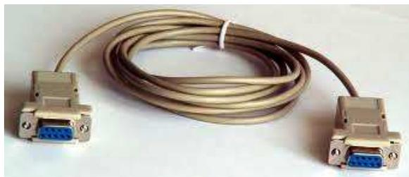
**Figura 4.7.** Cable de programación de la HMI
