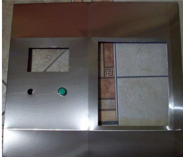
**Figura 4.30.** Instalación de luz piloto en la estructura del prototipo dispensador
