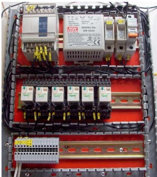
**Figura 4.23.** Implementación de Tablero de Control.
