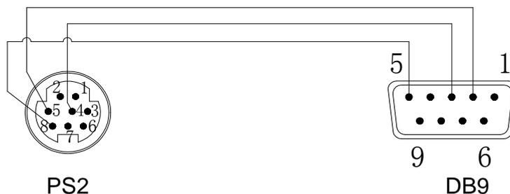
Figura 4.2. Conexión del cable de programación del PLC
