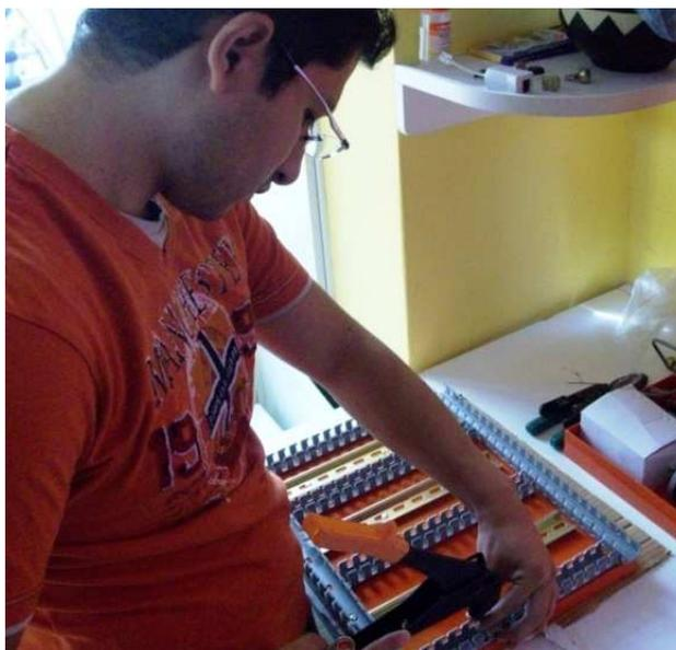
Figura 4.22. Implementación de Tablero de Control
