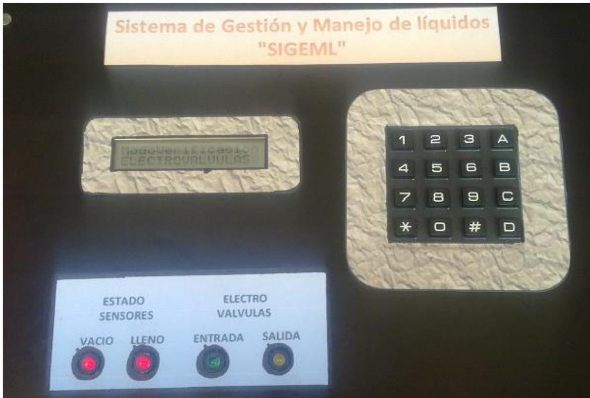
**Figura: 4.12 Caja sistema Micro procesado**
