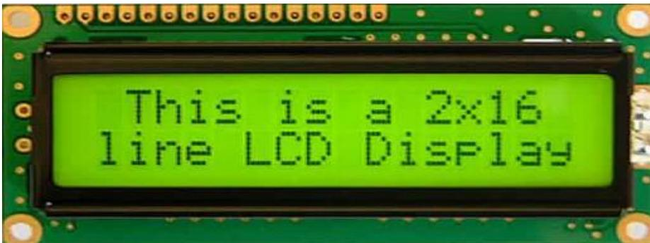
**Figura 2.5 Fotografía de un LCD 2x16 con controlador Hitachi**
