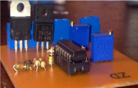
Figura: 4.5 Placa para el acondicionamiento del sensor de nivel tipo boya
