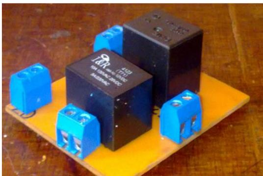
**Figura: 4.7 Placa de control de electroválvulas**
