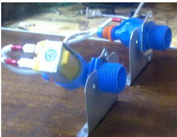
**Figura: 4.19 electroválvulas de entrada y salida**
