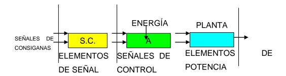
Fig. 2.7 Diagrama esquemático de un sistema de control de lazo abierto<sup>42</sup>
