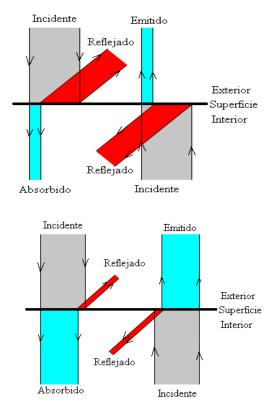
Fig. 2.18 Absorción y emisión de radiación
