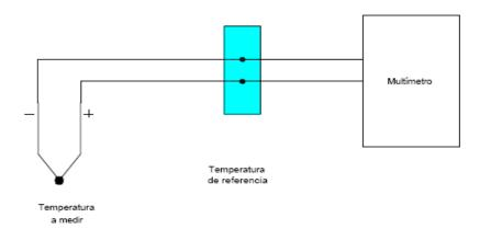
Fig. 2.29 Diagrama esquemático de una termocupla, incluyendo el instrumento de medición y la temperatura de referencia<sup>87</sup>.
