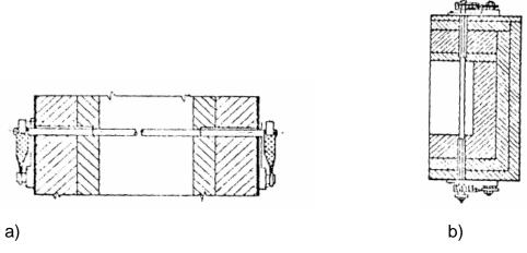
Fig. 2.39 Posición de las resistencias no metálicas en los hornos. a) Montaje horizontal; b) montaje vertical. 103
