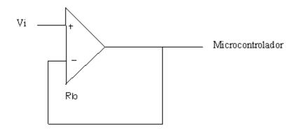
Fig. 3.10 Seguidor de tensión Elaborado por: Jose Freire
