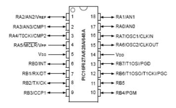
Fig. 3.15 Diagrama de conexión del PIC16F628A
