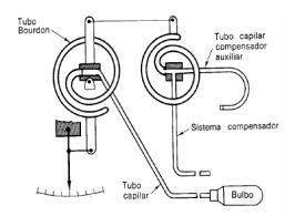
Fig. 2.20 Termómetro por expansión liquida totalmente compensada<sup>60</sup>
