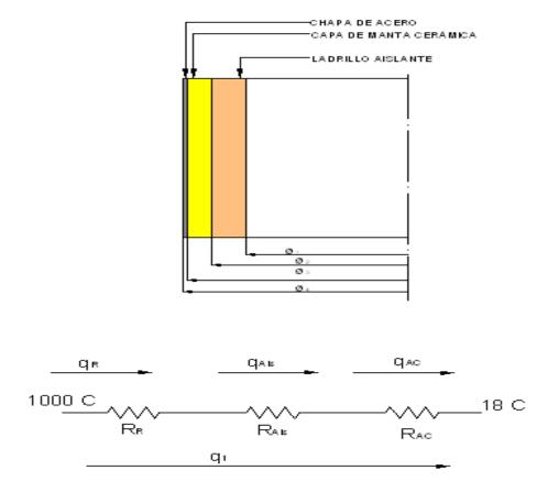
Fig. 3.5 Diagrama de la pared de la cámara Elaborado por: José Freire
