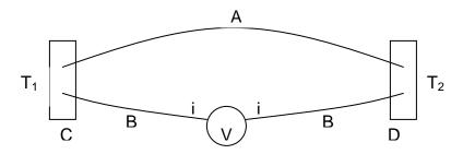
Fig. 2.15 Esquematización de la ley de metales intermediarios a temperatura únic
