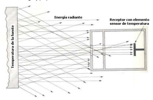
Fig. 2.48 Esquema simplificado de un pirómetro de radiación
