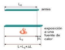
Fig. 2.3 Un sólido expuesto a una fuente de calor se dilata.
