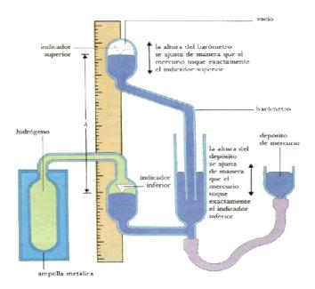
Fig. 2.21 El termómetro de gas a volumen constante<sup>63</sup>
