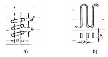
Fig. 2.38 Formas de las resistencias metálicas. a) Helicoidal, b) Zig-Zag
