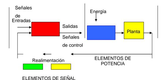
Fig. 2.8 Diagrama esquemático de un sistema de control de lazo cerrado<sup>43</sup>
