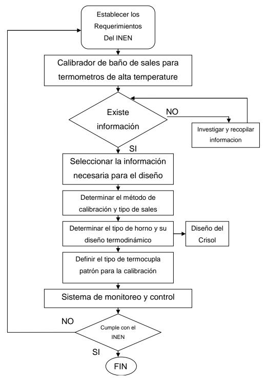
Fig. 3.1 Diagrama de bloques de los pasos para el diseño del Elaborado por: Jose Freire
