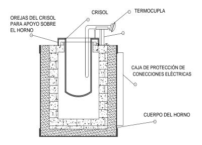
Fig. 3.2 Diagrama de los elementos del horno Elaborado por: José Freire
