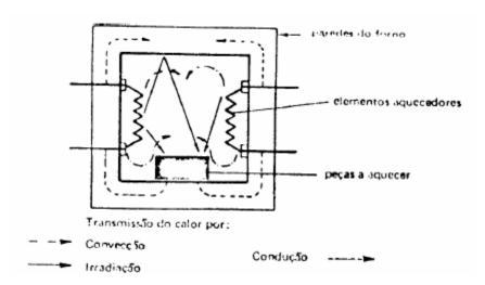
Fig. 2.36 Horno de resistencia con calentamiento indirecto.
