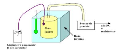
Fig. 2.28 Diagrama esquemático de un termómetro de gas.
