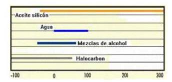
Fig. 2.32 Temperaturas que alcanzan las sustancias para esta aplicación medida en °C°3
