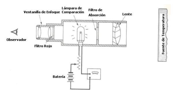
Fig. 2.46 Diagrama Esquemático de un pirómetro óptico
