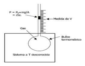
Fig. 2.23 termometro por presión de gas<sup>65</sup>
