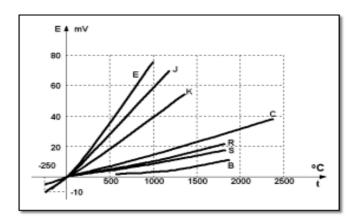
Fig. 2.13 Curvas de las diferentes aleaciones de las termocuplas<sup>48</sup>
