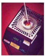
Fig. 2.33 Modelo de un horno de bloque en seco95
