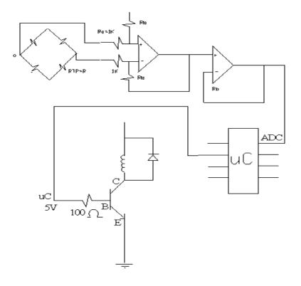
Fig. 3.13 Diagrama de conexión del circuito
