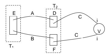
Fig. 2.16 Esquematización de las leyes de termocuplas.
