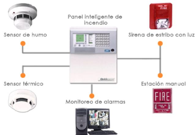
Figura 17. Esquema de Elementos Detectores de Incendios
