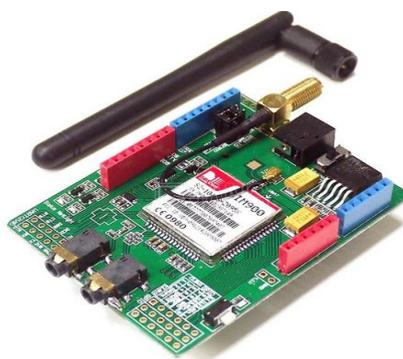
Figura 2.9: Módulo GSM SIM900
