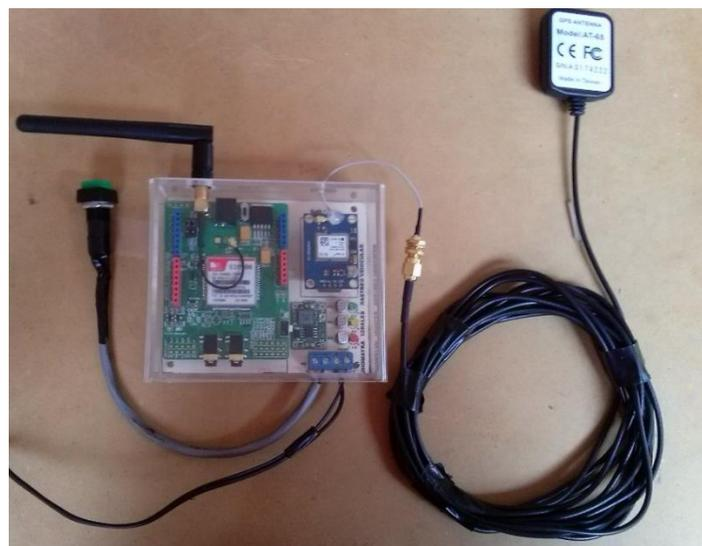
Figura 3.32: Dispositivo de rastreo vehicular armado con su tapa
