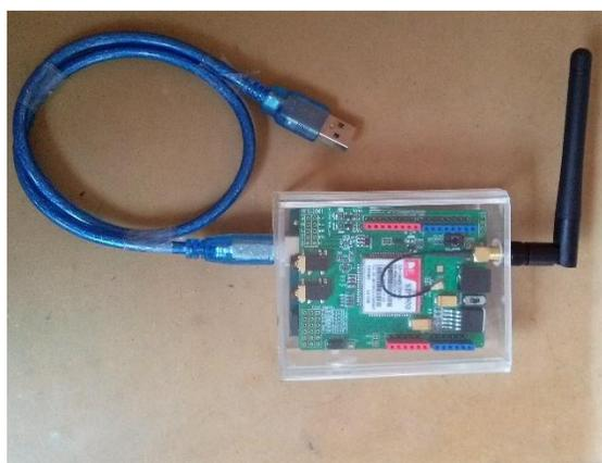
Figura 3.34: Dispositivo de control armado con tapa
