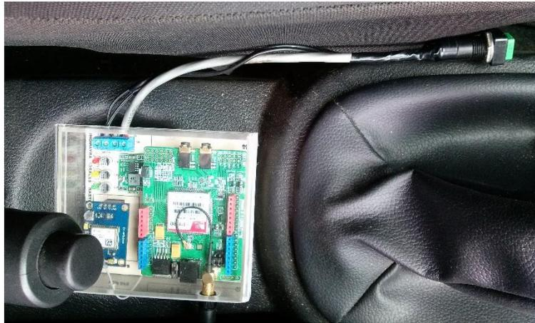
Figura 3.37: Implementación del dispositivo de rastreo en el vehículo de prueba 1
