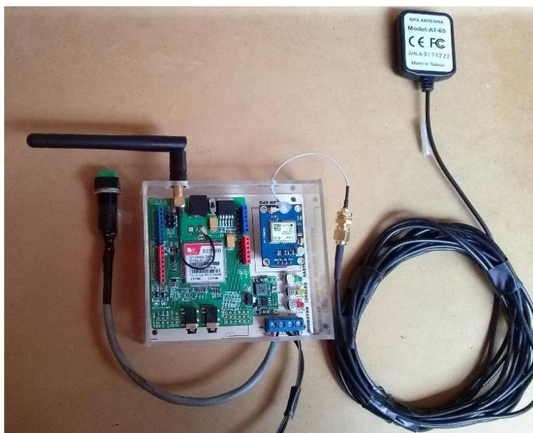
Figura 3.31: Placa del dispositivo de rastreo vehicular con sus respectivos módulos
