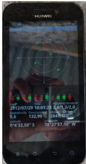
Fig. 3.17. Satélites captados por receptor BT-368i
