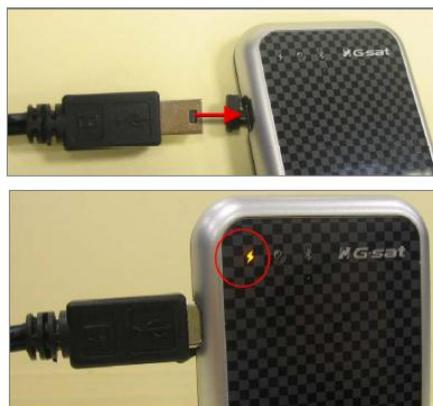
Fig. 3.15. Conexión cargador al receptor BT368i<sup>55</sup>
