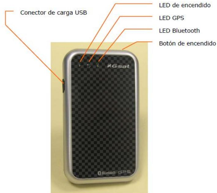
Fig 3.14. Descripción Hardware GPS BT-368i<sup>54</sup>
