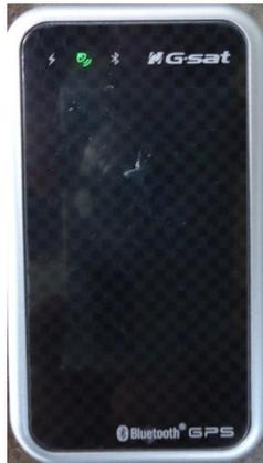
Fig. 3.32. Indicador LED de estado de conexión con satélites
