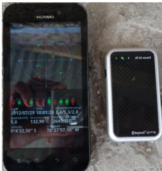
Fig. 3.34. Estado conexión del receptor BT-368i
