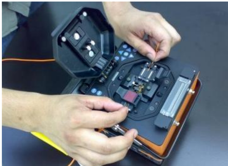
Figura 2.18. Empalme por fusión 23
