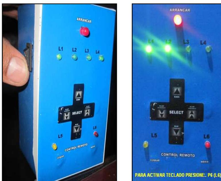
Figura 3.43. Caja del módulo de circuito de transmisor con LED vista frontal
