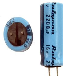
Figura 2.5. Condensador electrolítico<sup>5</sup>
