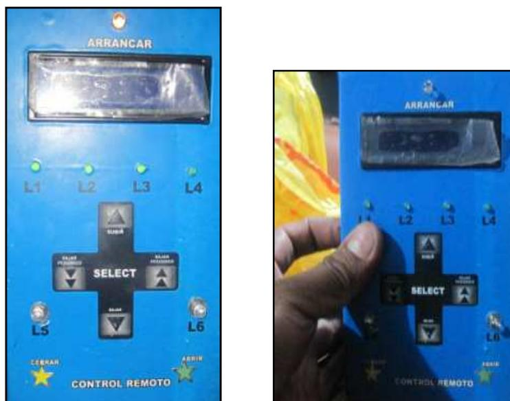
Figura 3.44. Caja del módulo de circuito de transmisor con LCD vista frontal
