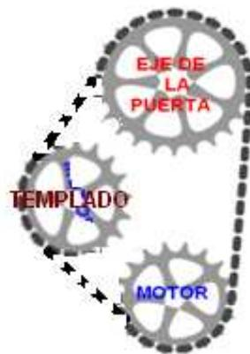
Figura 2.32. Acople de los engranajes a través de cadena
