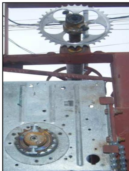
Figura 3.27. Acoplamiento a través de cadena con dos engranajes.
