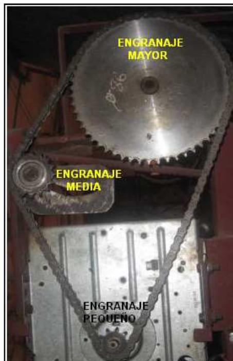
Figura 3.28. Acoplamiento a través de cadena con tres engranajes.
