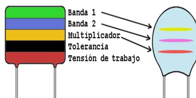
Figura 2.6. Representación física del Condensador por color<sup>6</sup>
