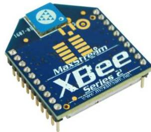
Figura 2.22. Representación física del XBEE
