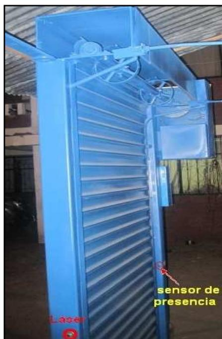
Figura 3.51. Implementación del acoplamiento del sensor de presencia
