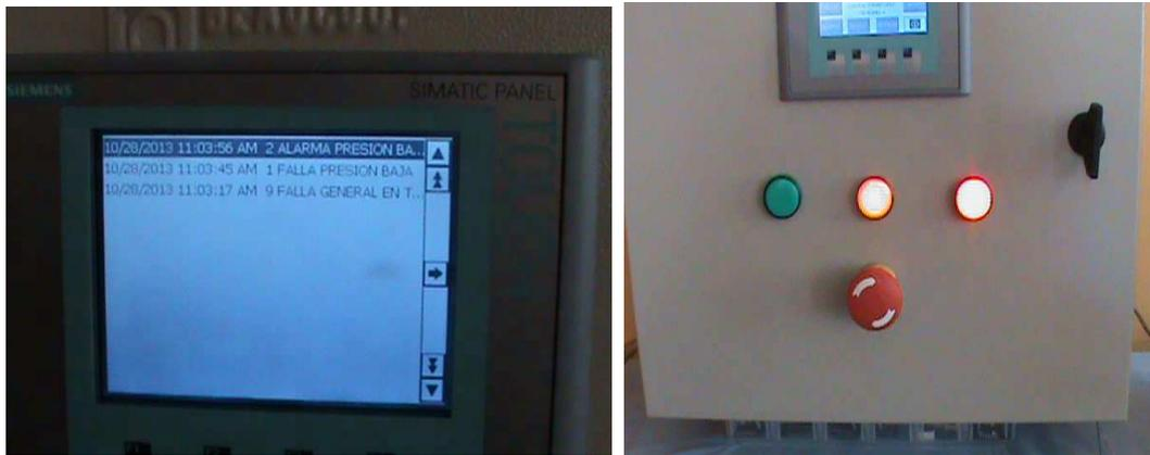
Figura 3.54 Alarmas y fallas presentes en prototipo.
