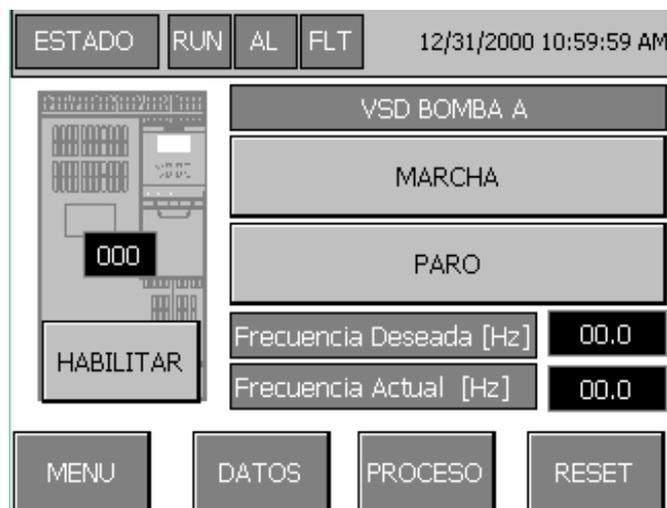
Figura 3.48 Configuración de arranque de VSD.
