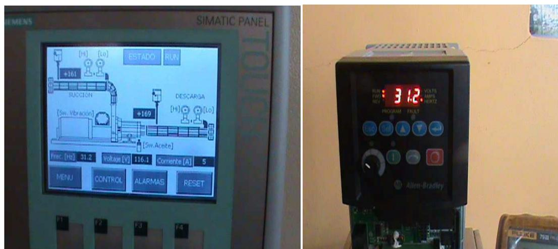
Figura 3.57 Registro de datos prototipo y VSD.
