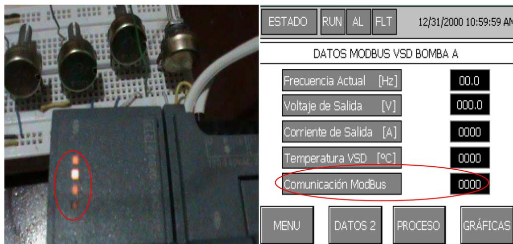
Figura 3. 45 Estatus de comunicación MODBUS del prototipo.
