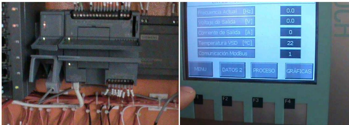
Figura 3. 53 Comunicación MODBUS establecida.
