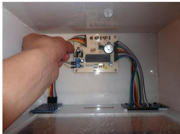
Figura 3.44: Placa electrónica y conexión de la fuente de energía.
