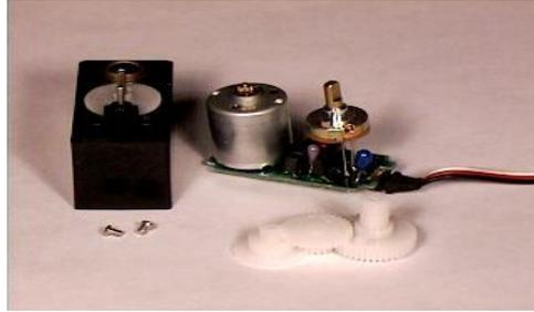
Figura 2.9: Partes principales internas de un servomotor.
