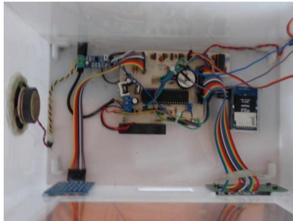
Figura 3.47: Implementación del módulo de tonos polifónicos.
