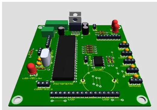
Figura 3.41: Diseño de la placa del sistema vista en 3D.
