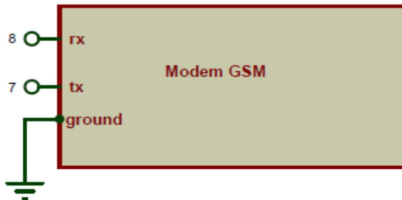
Fig. 3.4 Diagrama circuitual del módulo SIM 900.
