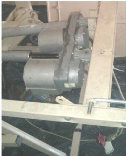
Figura 3.7 Dos Motores de Inversión de giro
