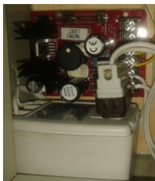
Figura 67. Fuente de voltaje con alto amperaje Fuente: Investigador
