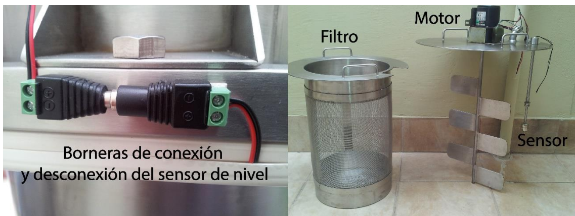
Figura 48. Conector sensor de nivel. Canastilla filtro. Motor y sensor de nivel.
