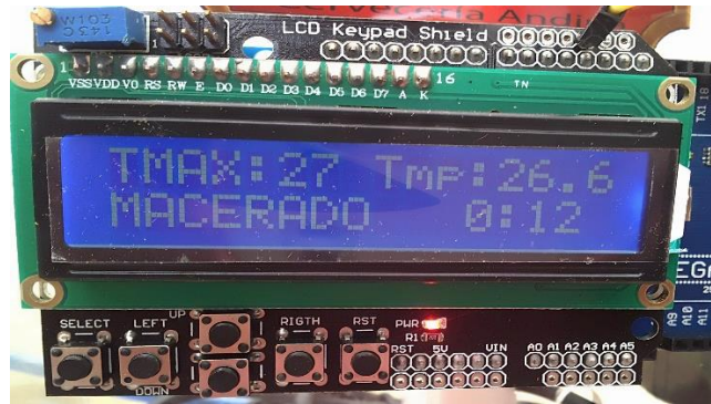
Figura 47. Mensaje de temperatura máxima. Temperatura actual y tiempo de macerado para obtención del mosto.
