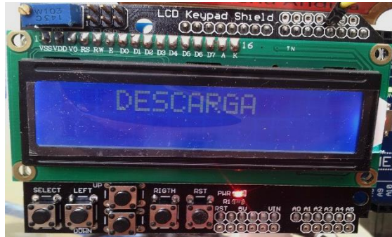
Figura 52. Aviso de descarga del tanque.
