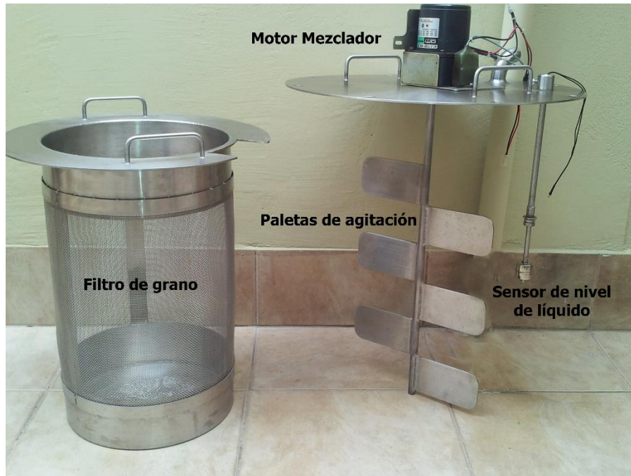
Figura 34. Motor mezclador y sensor de nivel de líquido
