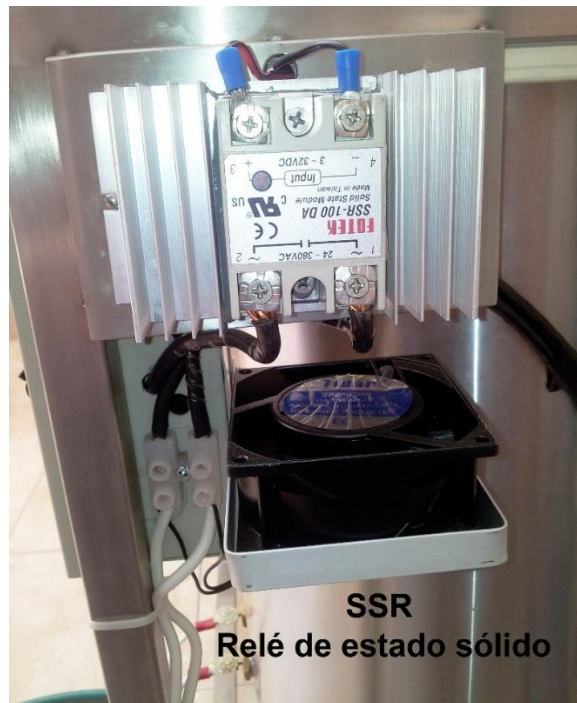
Figura 35. Relé de estado sólido para el control de la niquelina de inmersión
