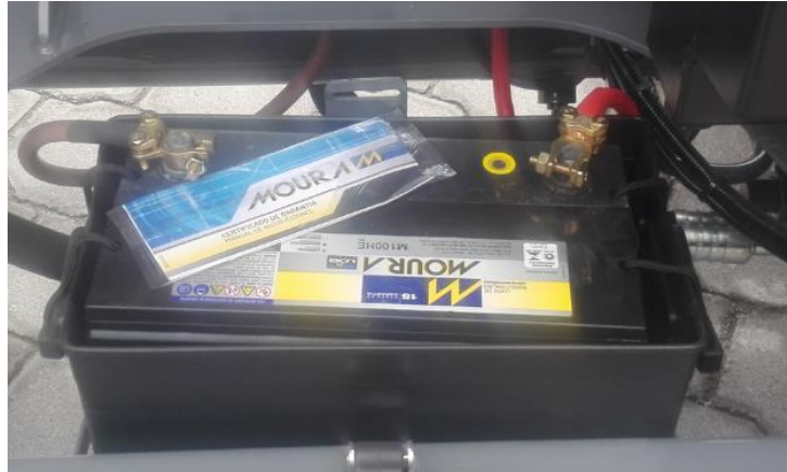
Figura. 12 Batería instalada en bomba de hormigón Fuente: autor
