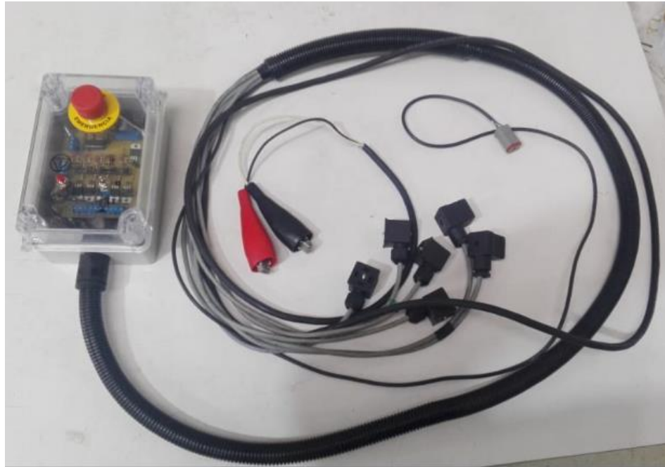
Figura. 30 Automatización del arnés de operación de emergencia Fuente: autor
