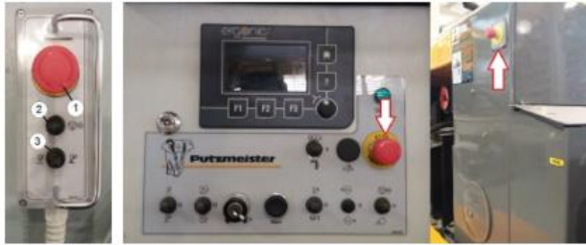
Figura. 16 Botón de emergencia Fuente: Putzmeister, manual de operación bomba de hormigón TK 50
