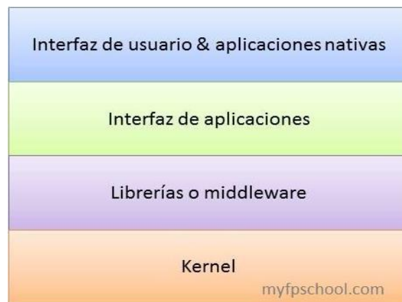
Gráfico N° 2 Estructura sistema operativo Android (myfpschool, 2017)
