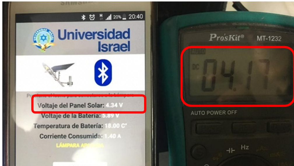
Figura 83. Comparación de voltaje entre el sistema y un multímetro
