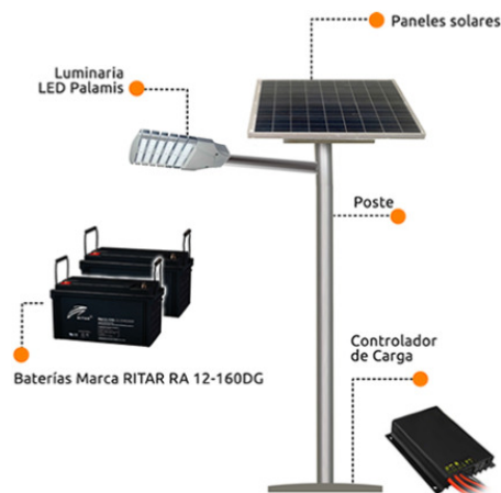
Figura 27. Componentes del sistema de iluminación Fuente: (Group, 2017)
