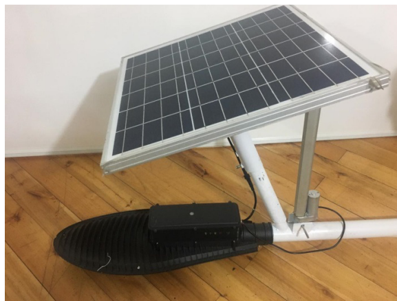
Figura 57. Aplicación del panel al mecanismo
