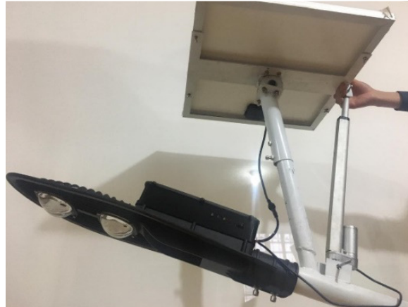
Figura 63. Sistema de iluminación terminado
