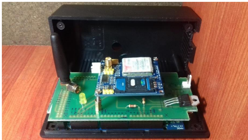
Figura. 4.11. Carcasa de protección
