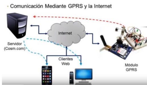
Figura. 1.6. Esquema de comunicación mediante GPRS
