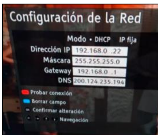
Figura 1. Configuración de la tarjeta de red del STB
