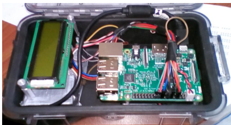
Figura 4.2 Conexiones de módulo Raspberry con LCD
