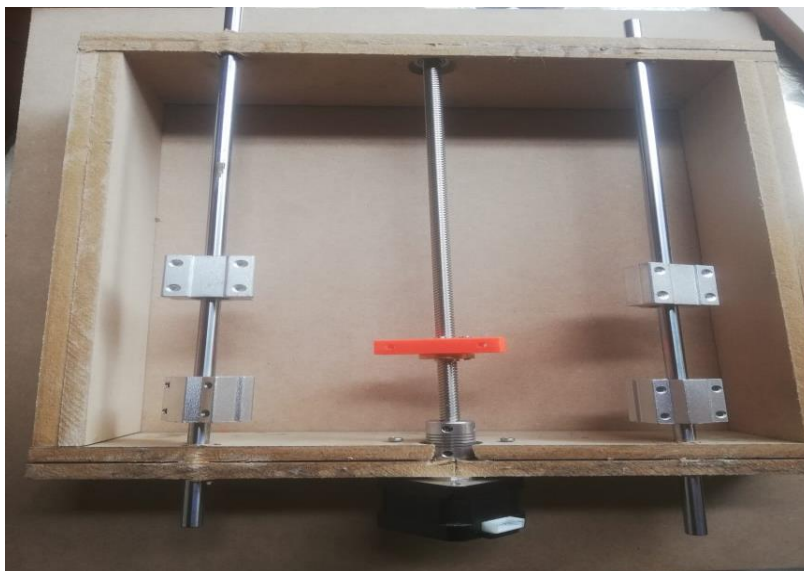
Figura 4. 6 Montaje de eje Y
