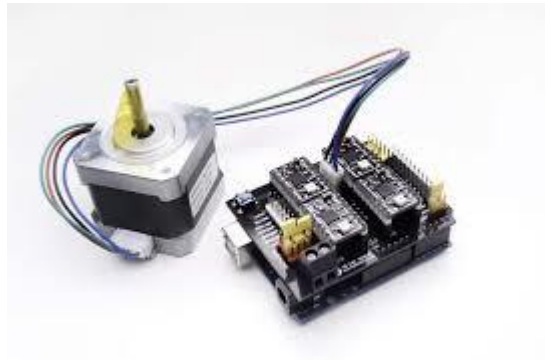
Figura 4. 17 Montaje del motor paso a paso al módulo
