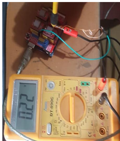
Figura 4. 14 Calibración driver A4988 del eje Z
