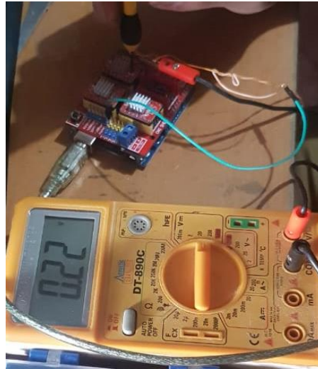
Figura 4. 13 Calibración driver A4899 del eje Y
