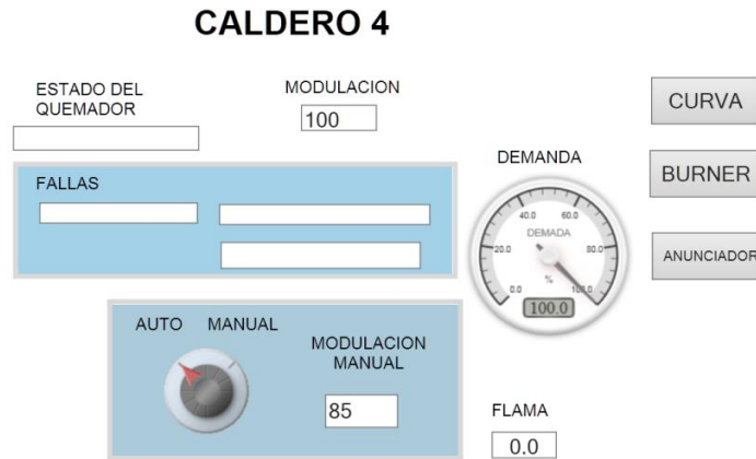
Figura 4. 9 Pantalla HMI de control de la caldera
