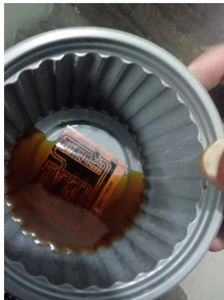
Figura. 0.99. Proceso químico retiro de cobre
