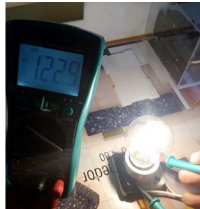
Figura. 0.113. Medida de voltaje
