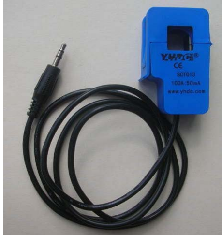
Figura. 0.31. Sensor de corriente no invasivo
