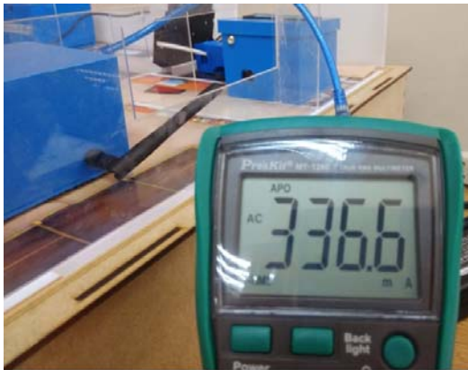
Figura. 0.112. Medida de la corriente en miliamperios
