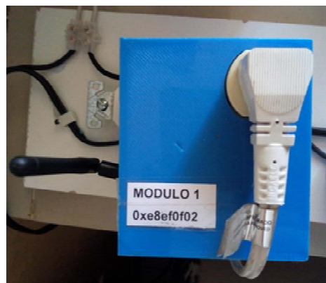
Figura. A.5. Aparato eléctrico conectado al módulo de medida
