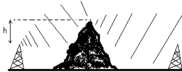
Figura 1.4 Difracción de ondas en radioenlaces.
